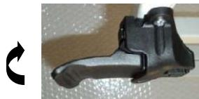
Pour commander l'ouverture du vérin à gaz, pousser vers le haut le levier de commande placé sous la section correspondante de la table. Monter ou baisser la section concernée jusqu'à ce que l'inclinaison souhaitée soit atteinte.
